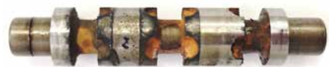
Slika 9 : Krmilni bat AIDRO ventila HD3-AMPS-1PC-R4/10 po štirih dneh neuporabe
