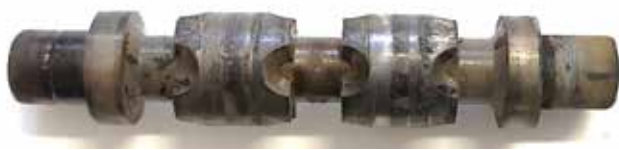
Slika 12 : Krmilni bat AIDRO ventila HD3-AMPS-1PC-R4/10 po 2 000 000 ciklih
