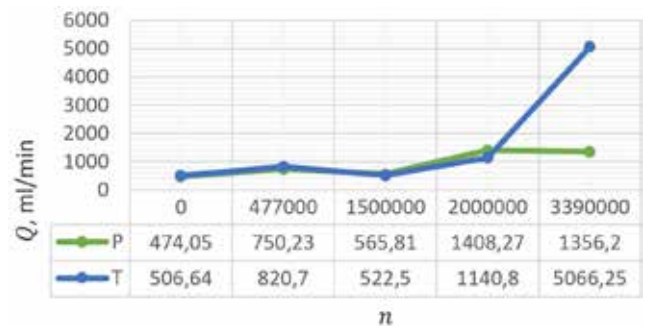
Slika 18 : Spreminjanje notranjega puščanja vode skozi AIDRO-v proporcionalni potni ventil v odvisnosti od opravljenih ciklov s tlakom 300 bar na vodu B
