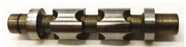
Slika 6 : Krmilni bat AIDRO ventila HD3-AMPS-1PC-R4/10 pred začetkom trajnostnega preizkusa z vodo
