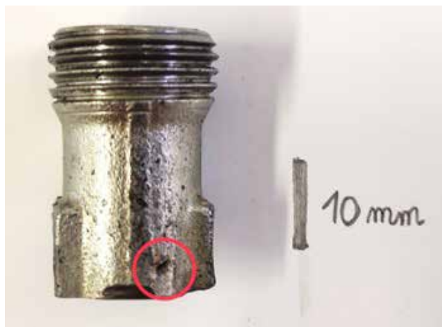
Slika 10 : Del kolena z vidno poškodbo, nastalo zaradi vodnega curka
