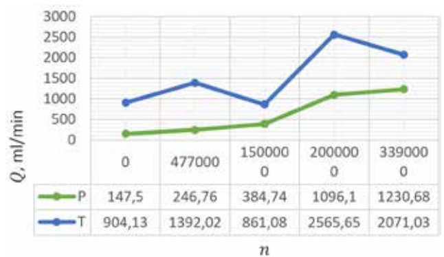
Slika 17 : Spreminjanje notranjega puščanja vode skozi AIDRO-v proporcionalni potni ventil v odvisnosti od opravljenih ciklov s tlakom 300 bar na vodu A
