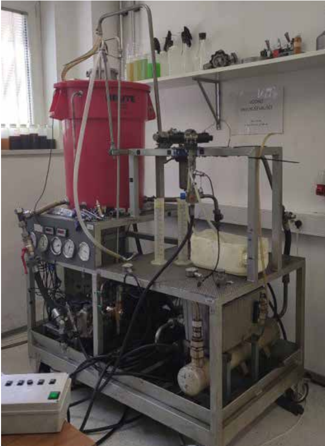
Slika 2 : Vodno preizkuševališče za prvo merjenje notranjega puščanja
