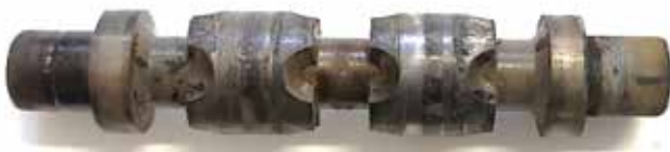
Slika 15 : Krmilni bat AIDRO ventila HD3-AMPS-IPC-R4/10 po 3 390 000 ciklih pred čiščenjem
