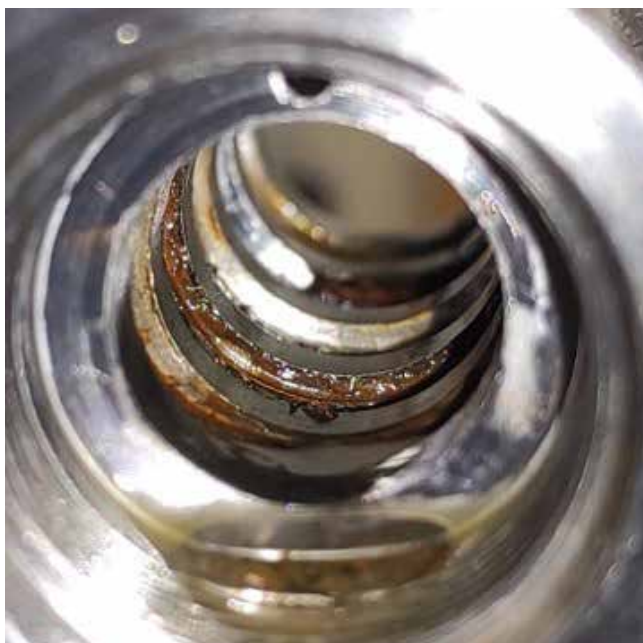
Slika 8 : Detajl notranjosti hišja AIDRO ventila HD3-AMPS-1PC-R4/10 po štirih dneh neuporabe
