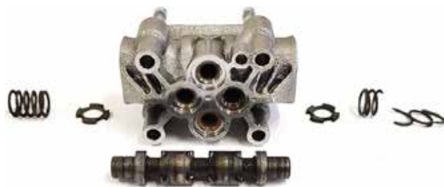
Slika 11 : Spodnji del ohišja brez O-tesnil, krmilni bat, podložki in originalni vzmeti AIDRO ventila HD3-AMPS-1PC-R4/10 po 1 500 000 ciklih
