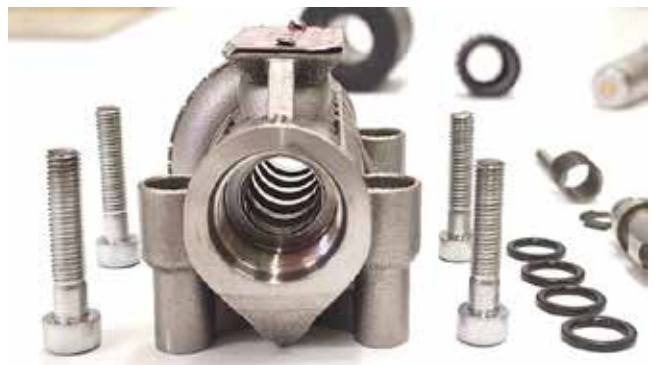
Slika 7 : Ohišje s pritrdilnimi vijaki AIDRO ventila HD3-AMPS-1PC-R4/10 pred začetkom trajnostnega preizkusa z vodo
