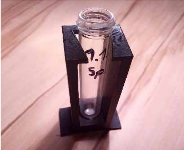
Slika 16 : Sušenje delcev v odprti epruveti na podstavku
