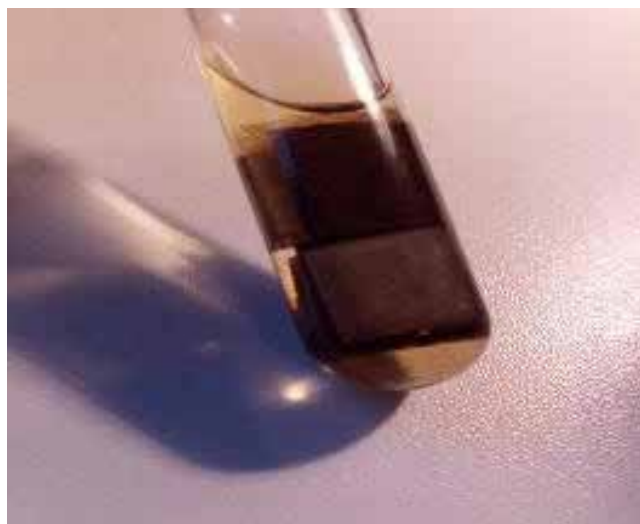
Slika 13 : Zmes alkohola in olja, ki se obarva rjavo
