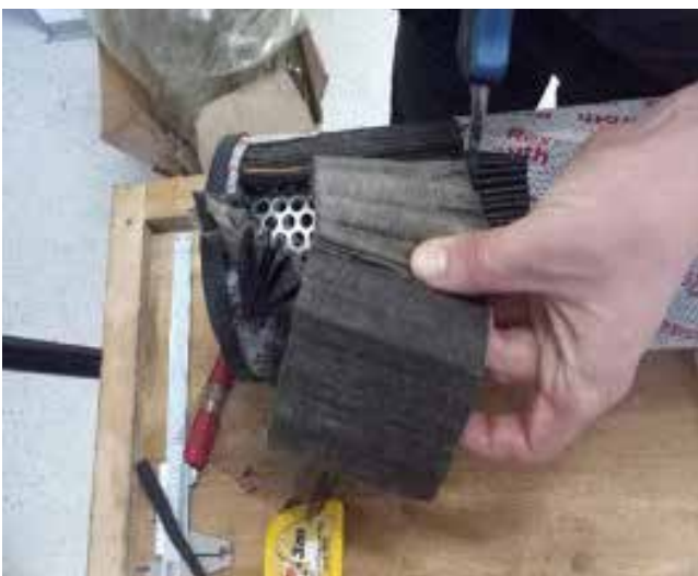
Slika 10 : Izrezovanje dela filtra
