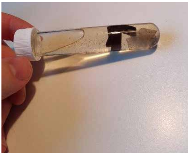
Slika 12 : Vzorci filtra v epruveti, zaliti z alkoholom
