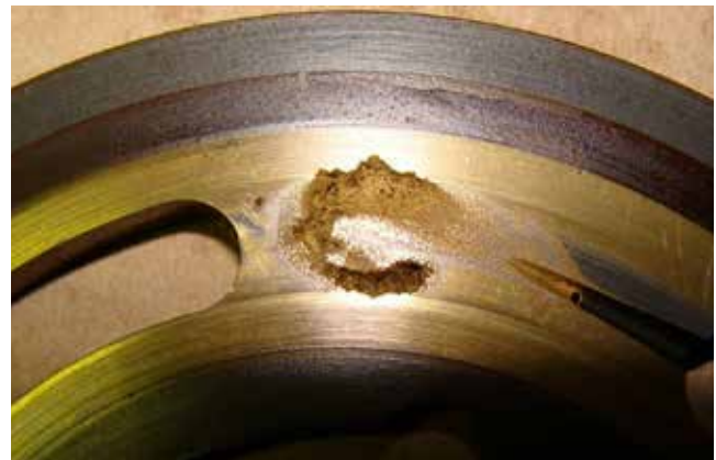
Slika 3 : Posledica kavitacijske obrabe na ventilski plošči hidravlične črpalke [6]
