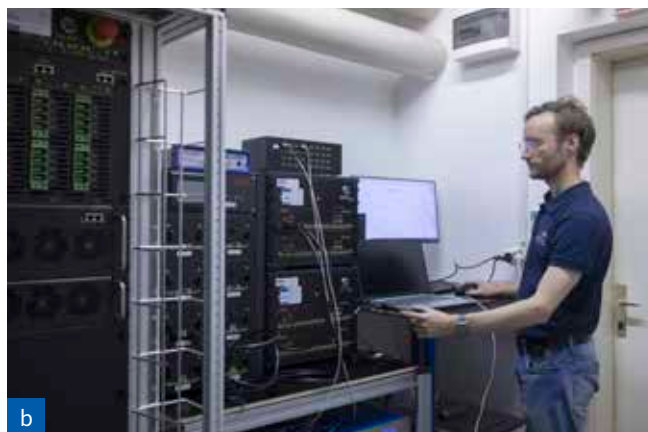
a) Baterijska ciklerja Arbin RBT in LBT za natančne, ponovljive in digitalno sledljive teste delovanja, staranja in diagnostike baterijskih celic (Foto: Laboratorij LICeM); b) Večconska temperaturna komora MZTC z osmimi neodvisnimi predali za sočasno testiranje baterijskih celic pri različnih temperaturah (Foto: Laboratorij LICeM)
