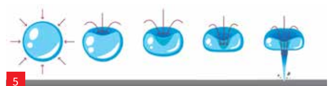
Kolaps posameznega kavitacijskega mehurčka [14]
