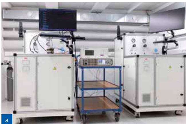
a) Baterijska ciklerja Arbin RBT in LBT za natančne, ponovljive in digitalno sledljive teste delovanja, staranja in diagnostike baterijskih celic (Foto: Laboratorij LICeM); b) Večconska temperaturna komora MZTC z osmimi neodvisnimi predali za sočasno testiranje baterijskih celic pri različnih temperaturah (Foto: Laboratorij LICeM)
