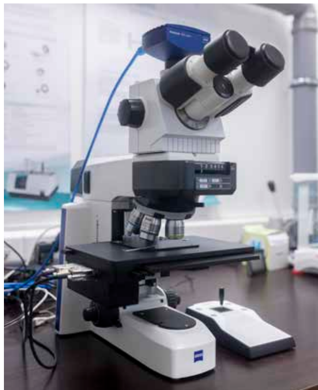
Sistem za karakterizacijo mikro toplotnih procesov: Thermtest THW-L1 ter mikroskopa ZEISS AxioScope 5 in ZEISS Stemi 305 (Foto: laboratorij LAHDE)
