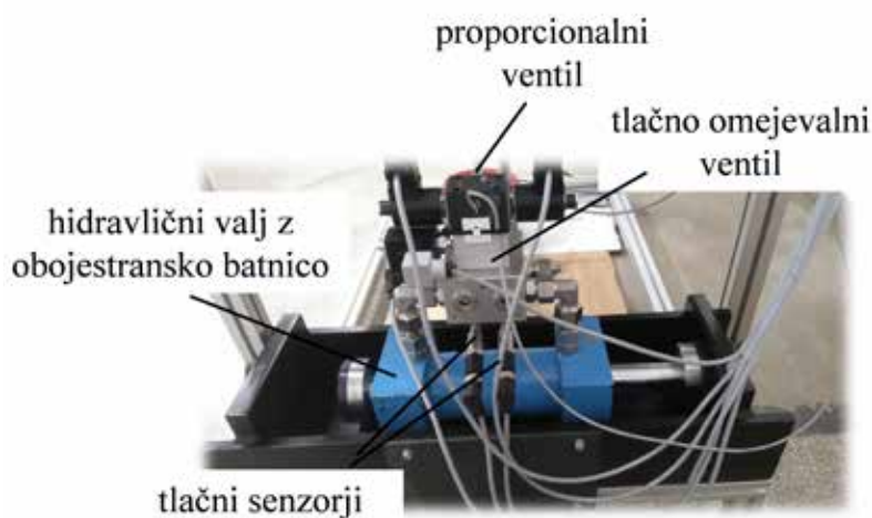
Slika 6: Bremenska enota (levo), krmilni signal ventila in profil spreminjanja tlaka (desno)
