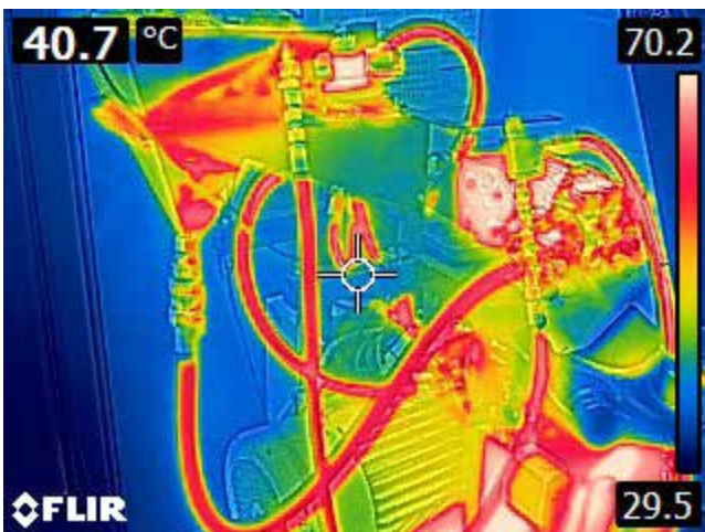
Slika 7 : Toplotne razmere na hidravličnem preizkuševališču med testiranjem
