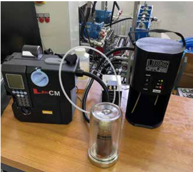
Slika 6 : Odstranjevanje zraka in meritev čistoče vzorca hidravličnega olja
