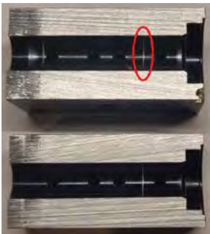
Slika 16 : Obe polovici prerezane- ga ohišja po trajnostnem testiranju
