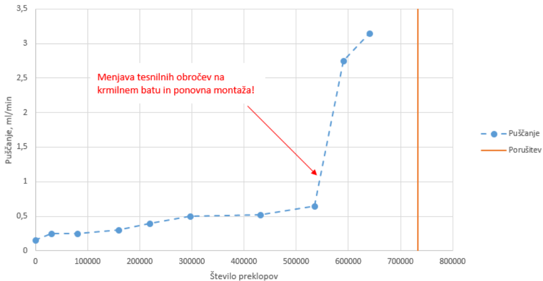
Slika 14 : Izmerjeno notranje puščanje ventila med trajnostnim testom
