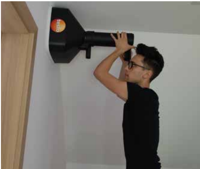
Slika 8 : Izvajanje meritev pretoka zraka z lijakom
