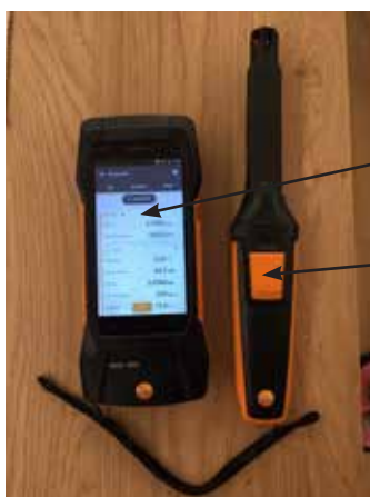
Slika 6 : Sonda za merjenje CO 2
