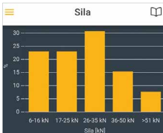
Slika 3 : Zaznavanje odstotka obremenitve vitla
