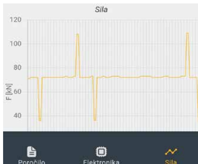
Slika 4 : Zapis merjene vlečne sile vitla
