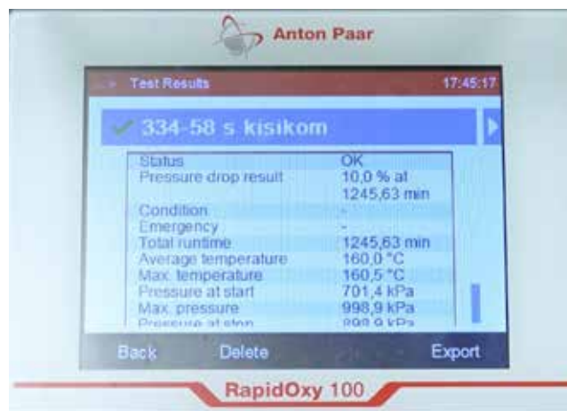
Slika 1 : Instrument RapidOxy 100 za merjenje oksidacijske stabilnosti olj
