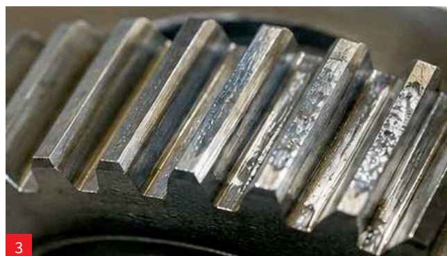
Obraba zobnika zaradi neustreznega mazanja (Vir: [7])
