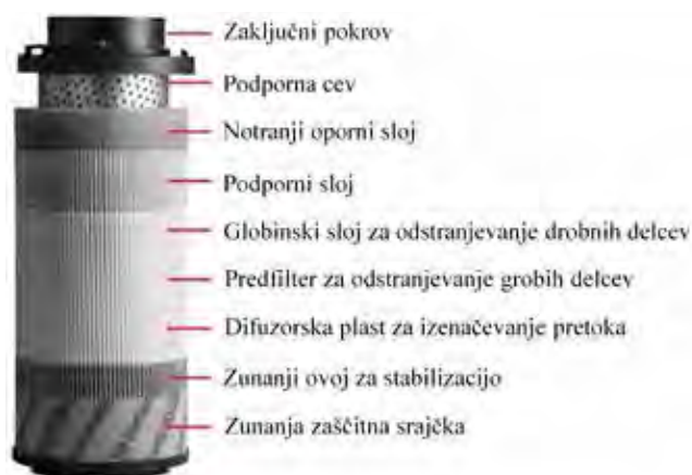
Slika 1 : Značilna zgradba filtrirnega vložka (vir slike: Hydac)
