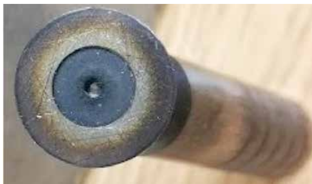
Slika 10 : Preobremenjen drsni čveljec aksialne batne črpalke zaradi zamašenega mazalnega kanala
