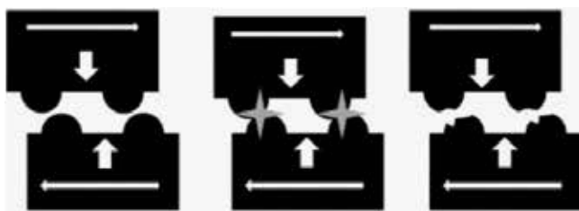
Slika 2 : Utrujnostna obraba – fizikalni princip
