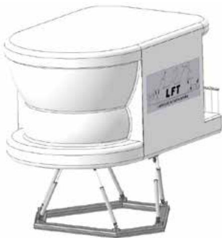
Slika 10 : Stewartova ploščad s prikazano letalsko kabino (4220 mm x 2815 mm x 3735 mm)
