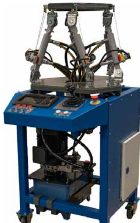
Slika 11 : Obstoječa manjša prototipna hidravlična Stewartova ploščad (685 mm x 844 mm x 1505 mm) [10, 11]
