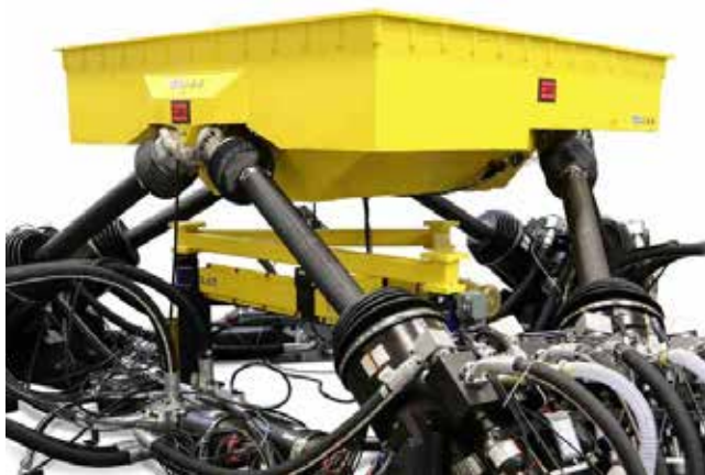
Slika 7 : Hidravlična simulacijska ploščad 353.50 (tloris 2500 mm x 2500 mm) [8]
