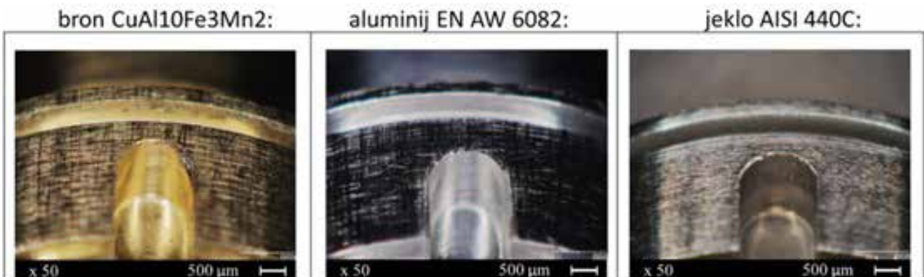
Slika 12: Krmilne zareze na batih pred trajnostnim testom
