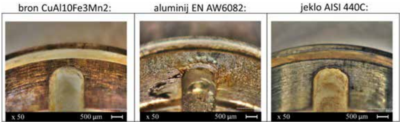
Slika 13: Obraba krmilnih zarez batov na strani P-voda po izvedenem trajnostnem testu
