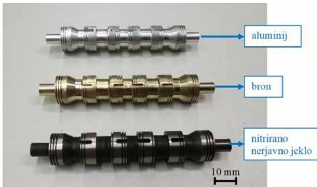
Slika 3 : Izdelani drsniki krmilni bati ( \Phi 12 mm x 75 mm) po brušenju
