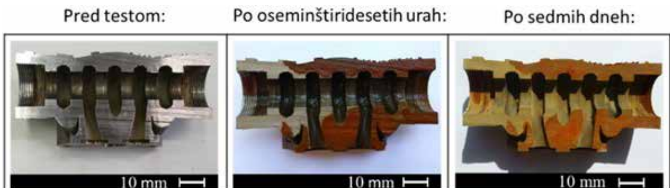
Slika 18: Spremljanje rjavenja razrezanega ohišja ventila pri namakanju v vodo
