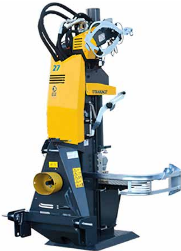
Slika 1 : Primer vertikalnega hidravličnega cepilnika drv proizvajalca Uniforest [4]
