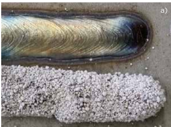
Slika 2 : Preliminarni testi z navarjanjem (levo) in v zv. žlebu na 30-milimetrski pločevini (desno)
