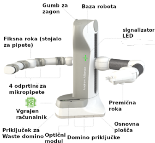
Slika 1: Predstavitev strojne opreme (struktura robotskega mehanizma)
