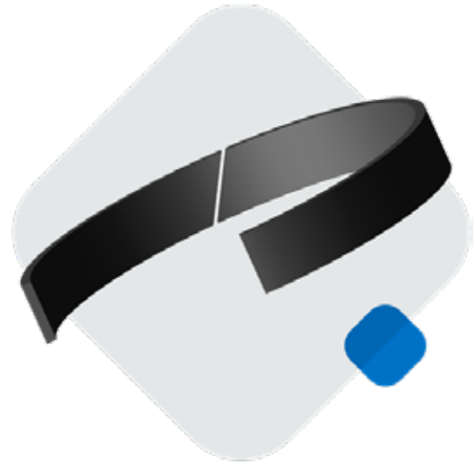
Slika 3 : Vodilni obroč Hallite 565 je izdelan za uporabo v srednje težkih do težkih hidravličnih aplikacijah in učinkovito preprečuje stik kovine s kovino med batom in izvrtino ali batnico ter glavo cilindra.
