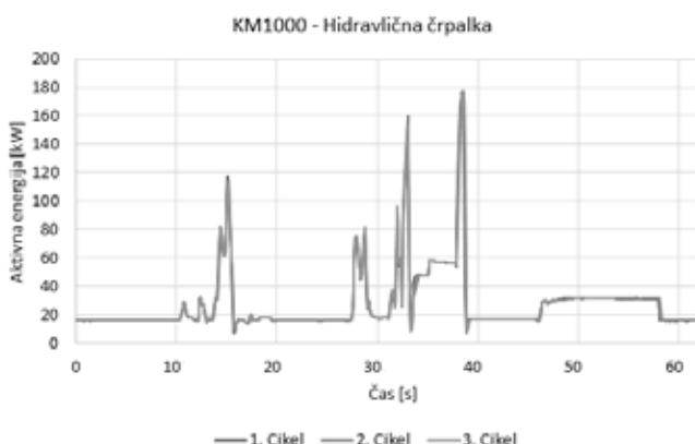
Slika 3 : Primerjava meritev treh zaporednih ciklov na pogonskem elektromotorju
