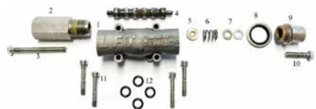
Slika 4 : Prikaz sestavnih delov ventila, uporabljenega pri testiranju
