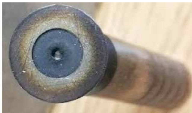
Slika 10 : Preobremenjen drsni čevljevca aksialne batne črpalke zaradi zamašenega mazalnega kanala
