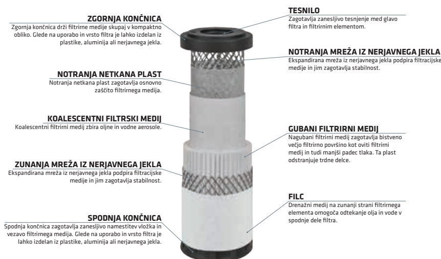
Slika 1 : Sestava filterskega vložka
