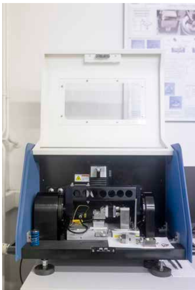
Slika 3 : Preizkuševališče za elektro-tribološko karakterizacijo mejnih površinskih filmov in kontaktov v širokem območju mehanskih, temperaturnih in električnih obremenitev (foto: Laboratorij TINT)
