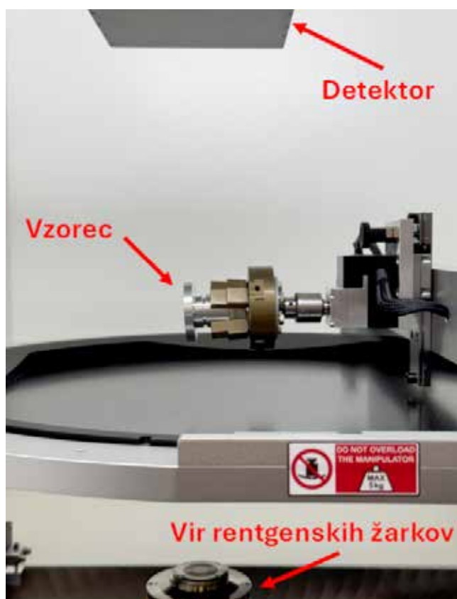
Slika 2 : Položaj vzorca v CT-skenerju
