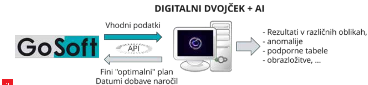
2 API-povezovanje GoSofta in digitalnega dvojčka. GoSoft zagotavlja vhodne podatke, digitalni dvojček vzpostavi model proizvodnega sistema, algoritmično oziroma AI-jedro podpira izračun plana, izbrani operativni rezultati se lahko vrnejo v GoSoft, podporni analitični izpisi pa ostanejo v analitičnem okolju digitalnega dvojčka.
