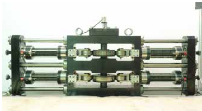
Prototip inovativnega pogonskega sistema za elastokalorično hlajenje s konstantnim navorom in povračanjem mehanskega dela.
