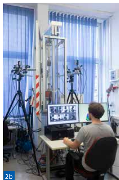
Detalj sistema osmih sinhroniziranih kamer za zajem slikovnih sekvenc (a) ter celoten merilni sistem za analizo mehanskih pojavov (b)
