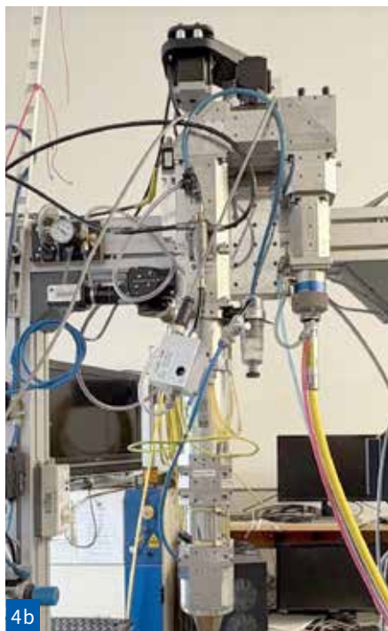
Napredni sistemi za 3D-tiskanje kovin za razvoj večmaterialnih komponent – (a) dvokanalni diskasti podajalnik kovinskega prahu, (b) sistem z DED-LB-glavo (Foto: LASIN).
