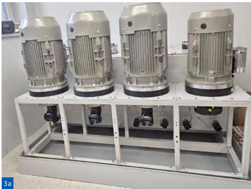
Hidravlično preizkuševališče v sklopu nove platforme za visokotlačne teste: pogonski del hidravličnega agregata (a) in električna omara (b) (Foto: LFT)
