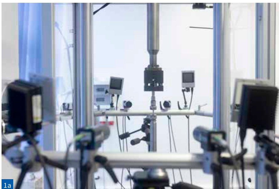
Detalj sistema osmih sinhroniziranih kamer za zajem slikovnih sekvenc (a) ter celoten merilni sistem za analizo mehanskih pojavov (b)
