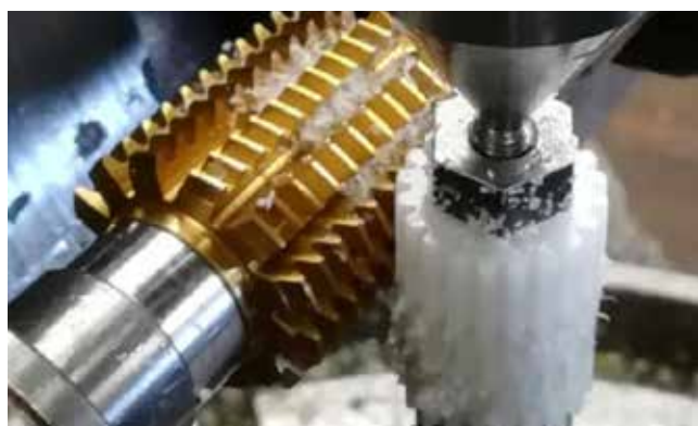
Slika 1 : Odvalno rezkanje testnih zobnikov
